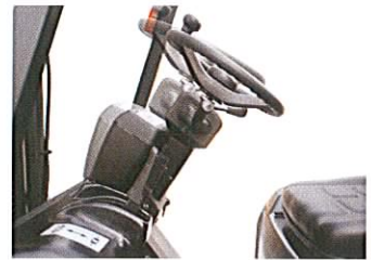
De verstelbare stuurkolom draagt bij aan een optimale werkhouding
