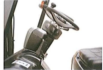
De verstelbare stuurkolom draagt bij aan een optimale werkhouding
